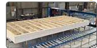
Matériaux de construction biosourcé à base de bois et de paille (e.g. murs et planchers)
