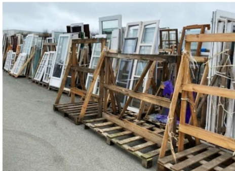
Figure 38 : Collecte en rack d'huissieries intégrées en vue de leur démantèlement en atelier – Source : Recovering
